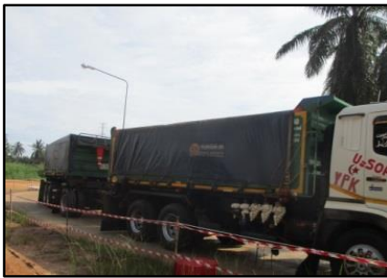
ภาพที่ 3.47 การใช้ผ้าใบปิดคลุมกระบะท้ายรถบรรทุกให้มิดชิด
